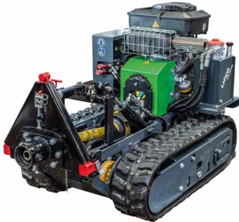
Der **Chronos** vereint die Vorteile eines Einachsers mit dem Komfort und der Sicherheit eines Raupenfahrzeuges.
