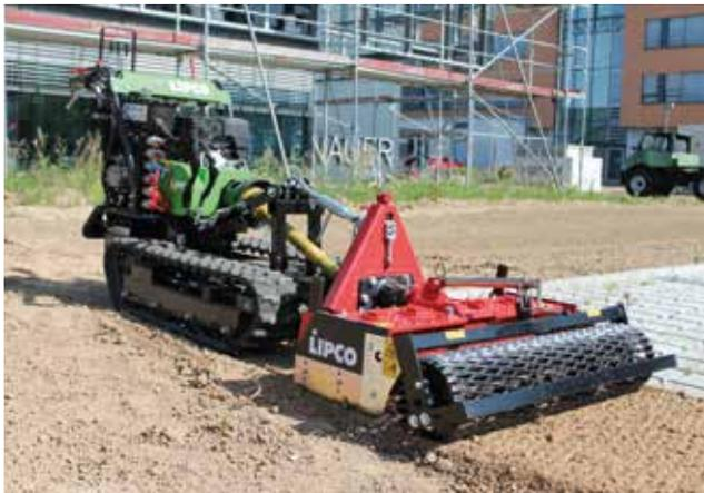
**!** Erde wird mit dem **Planierschild** verschoben. Ergänzen Sie die Kreiselegge um ein walzenseitiges Zusatzplanierschild und um eine Spindelverstellung für das serienmäßige Planierschild – so wird Ihre Kreiselegge zu einer wahren „Baumaschine“!
