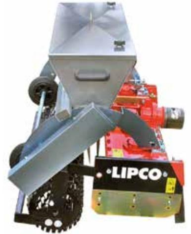
Abb.: Sämaschine Typ SM auf Uni-Kreiselegge Typ UK montiert
