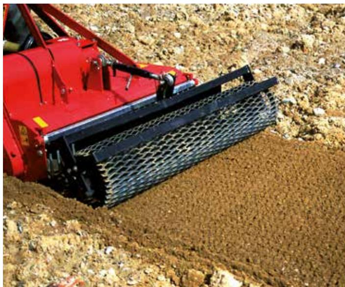
grobe Material gelegt. Die Umkehrfräse schafft in einer Überfahrt ein optisch perfektes Ergebnis. Bodenverdichtungen werden beseitigt, Bewuchs wird untergearbeitet.
