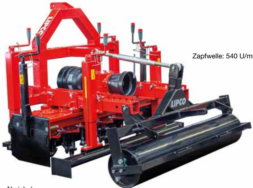
Zapfwelle: 540 U/min
