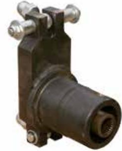
Fronthubwerk mit Frontzapfwelle für Traktoren bis 16 kW (22 PS), die ohne Frontzapfwelle ausgestattet sind. Die Kraftübertragung erfolgt von hinten mit Verlagerungsgetriebe und Gelenkwelle.
