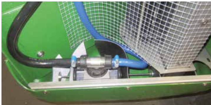
Sumpf mit Injektor GSG (Querstromgebläse)
