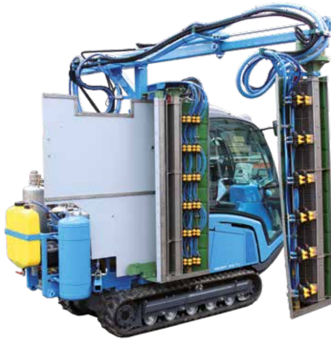
Nachrüstset für den Überzeilen-Einsatz im Weinbau, Außengebläse hydraulisch drehbar
