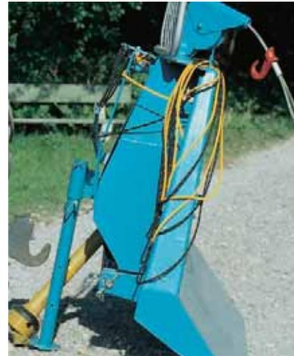
*Einfache Bedienung der Kupplung und Bremse über Seilzüge*
