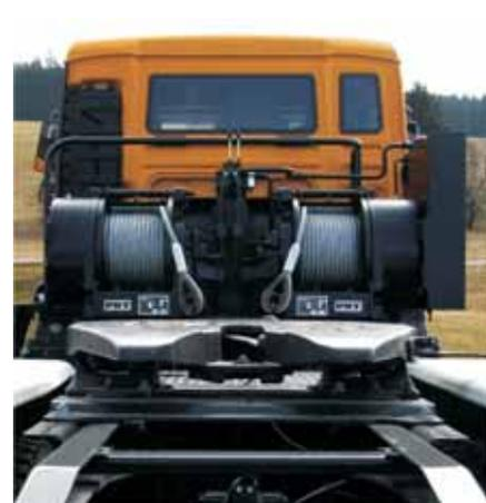
Doppelwinde 2 mal 250 kN
