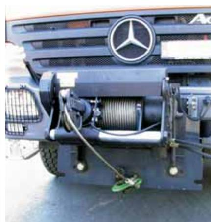
Frontanbauwinde 50 kN an Fahrzeugplatte nach DIN 76060
