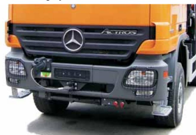
Festeinbau Rahmenwinde 70 kN mit Schwenkrolle
