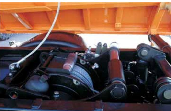
Rahmeneinbau 70 kN mit mechanischem Seilspulsystem
