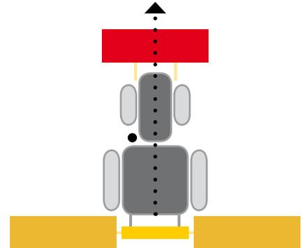
SMG multipla este compus din doua mulcere laterale legate de un dispozitiv central cu prindere in 3 puncte. Unghiul de lucru poate varia de la 90 la -60 grade. Masinile pot fii ridicate pentru transport si pentru parcare. SMG multipla combinat cu un mulcer OLS fh sunt ideale pentru intretinerea suprafetelor mari.
