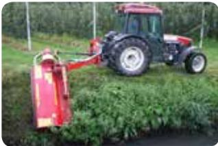
Das hydraulische Schwenken und die Seitenverschiebung machen diese Maschinen sehr vielseitig.
