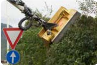
Die Kombination von Bagger und Mulchgerät ermöglicht es, auf unwegsamem oder schwer erreichbaren Lagen, auf steilen Hängen, unebenen Flächen oder in Sumpfbereichen zu mulchen. Sie sind ausgezeichnete Geräte für die Landschaftspflege, für die Pflege von Kanälen und Flussufern, von Strom- oder Gasleitungen.
