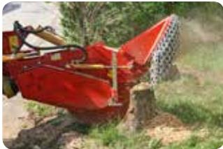
SEPPi M. Wurzelstockfräsen sind starke und leistungsfähige Geräte und mulchen Stubben bis zu 50 cm Tiefe mit jeglichem Durchmesser.
