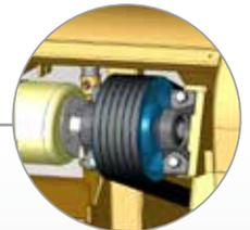
Antrieb mit Keilriemen-Spanner und Sicherheitskupplung
