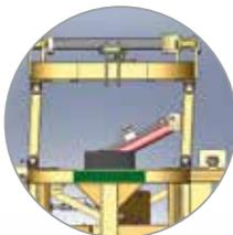
3-Punkt-Anbau mit Parallelogramm-Seitenverschiebung
