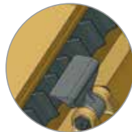
Gegenschneiden im Gehäuse verbessern das Mulchergebnis wesentlich
