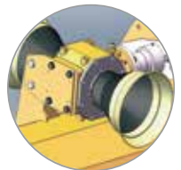
Getriebe mit Freilauf und Durchtriebswelle für die Frontfahrt
