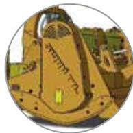
doppelter Antrieb mit 10 Keilriemen
