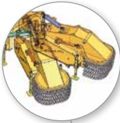
Schwenken von der Mitte nach links, zum Fräsen des ganzen Wurzelstocks
