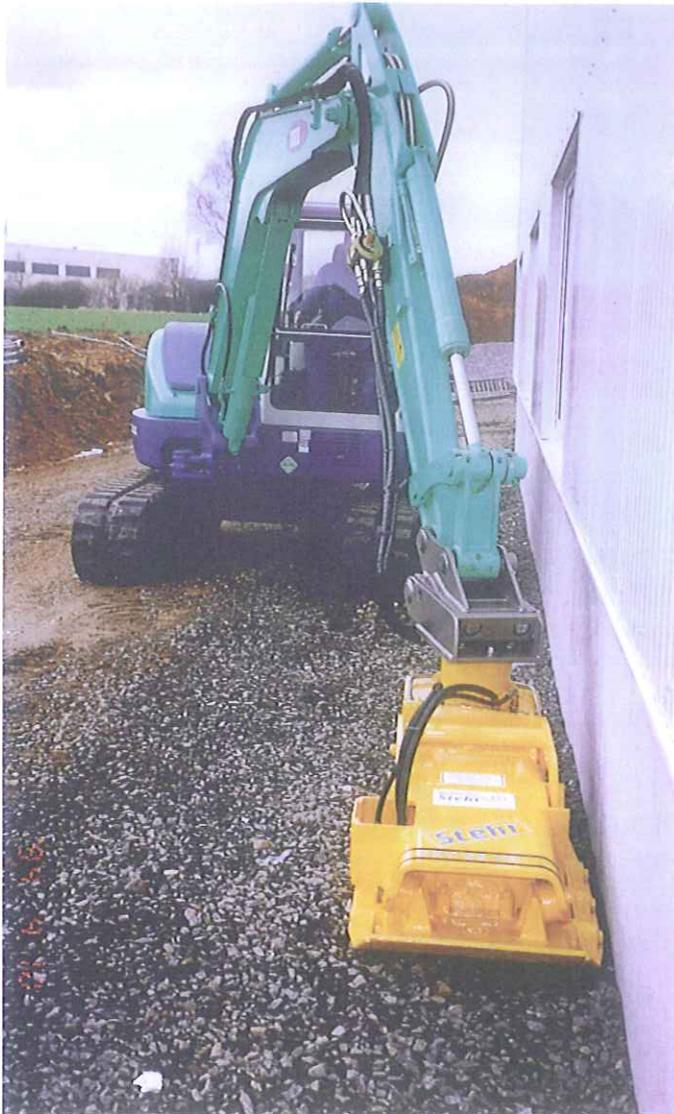
Der Plattenverdichter SBV 55 H1 d wurde entwickelt um die Verdichtungsprobleme im Kanalbau, bei Verfüllungen, Hinterfüllungen, im Gleisbau, Kanalverbau usw. zu lösen, wo ein Verdichten mit herkömmlichen Geräten nicht möglich ist. Die geringe Bauhöhe von nur 400 mm, das endlose 360 Grad drehen, ermöglicht den über den Baggerarm geführten Plattenverdichter in jede erdenkliche Lage zu positionieren. Über Schnellwechsler werden Anbaugeräte und Hydraulikschläuche sekundenschnell gewechselt.
