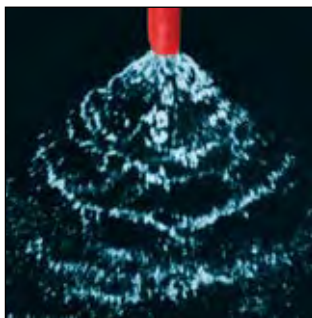
Scomposizione getto di spruzzo ugello ID ID-Düsenstrahl Descomposición del chorro de pulverización de la boquilla ID
